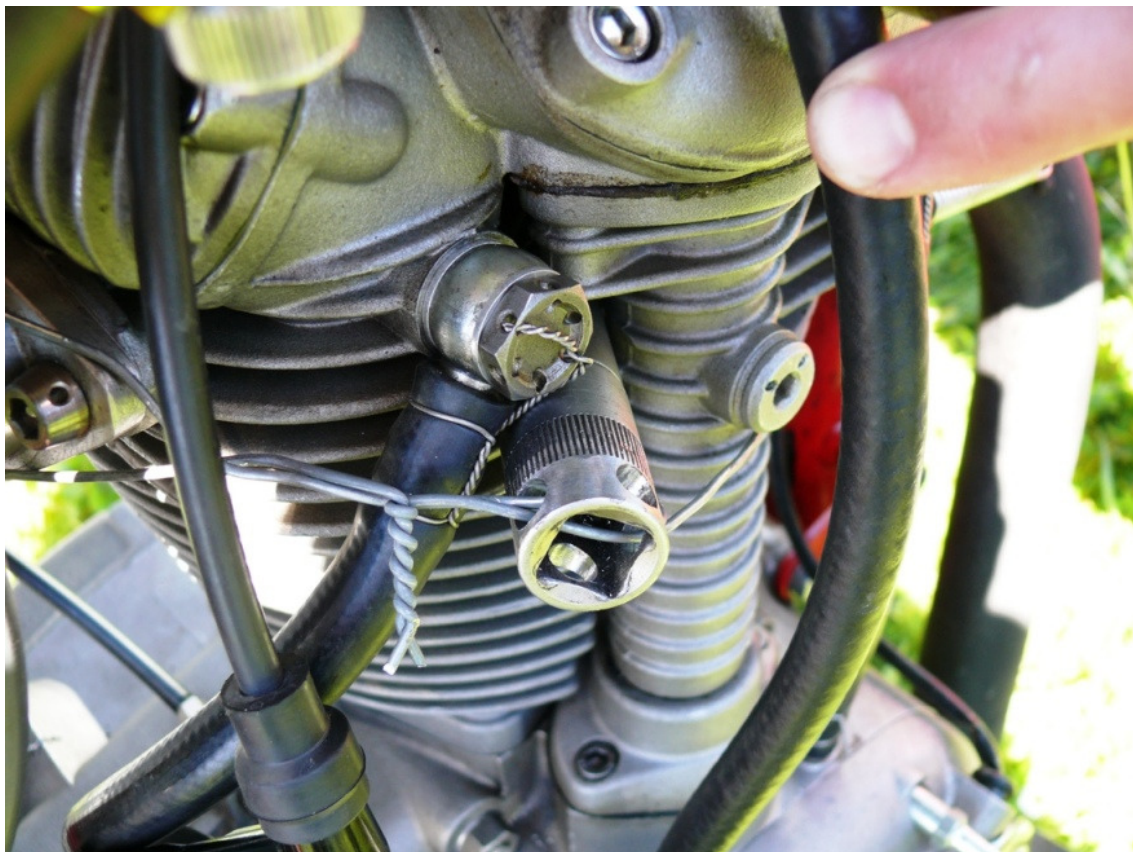
2-Komponenten-Kleber und Draht statt intaktes Kerzengewinde
